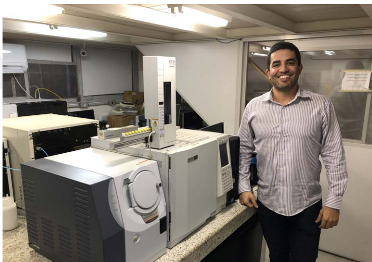
Acima, o pesquisador ao lado de um sistema de cromatografia gasosa acoplada à espectrometria de massas (GC-MS). Foto: LAABBM/IQ.
