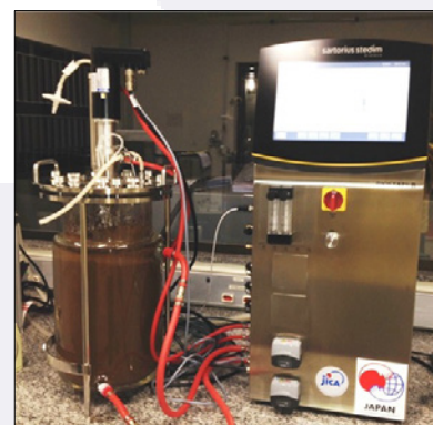
Biorreator para hidrólise enzimática de biomassa. Foto: LB-IQ.
