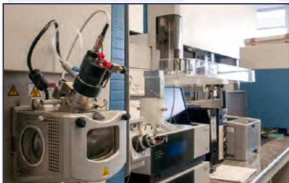
O Orbitrap (acima) é um espectrômetro de massas de alta resolução. Consegue detectar, rapidamente, centenas de substâncias em matrizes complexas como urina, sangue, petróleo, etc.
