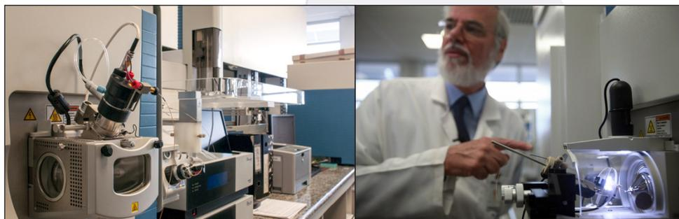
Cromatógrafos com fase líquida acoplados a espectrômetros de massas de alta resolução, com massa exata obtida por analisadores Orbitrap. Na foto à direita, o Prof. Radler à frente de equipamento do sistema de nano-eletronebulização para cromatografia em nano-escala. Foto: Divulgação Rio-2016.
