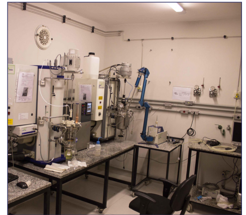
Laboratório de Calorimetria, onde são feitas avaliações de estabilidade de inibidores de incrustação.
