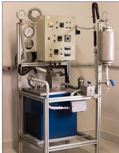
Reator para fluidos supercríticos que permite simulações de precipitações de carbonatos em altas pressões de CO 2 .
