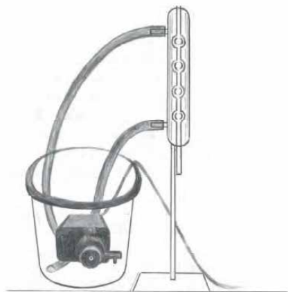
Bomba de circulação ligada a um condensador. Fonte: “A química perto de você. Experimentos de química orgânica”, Angelo C. Pinto e Bárbara Vasconcellos da Silva
