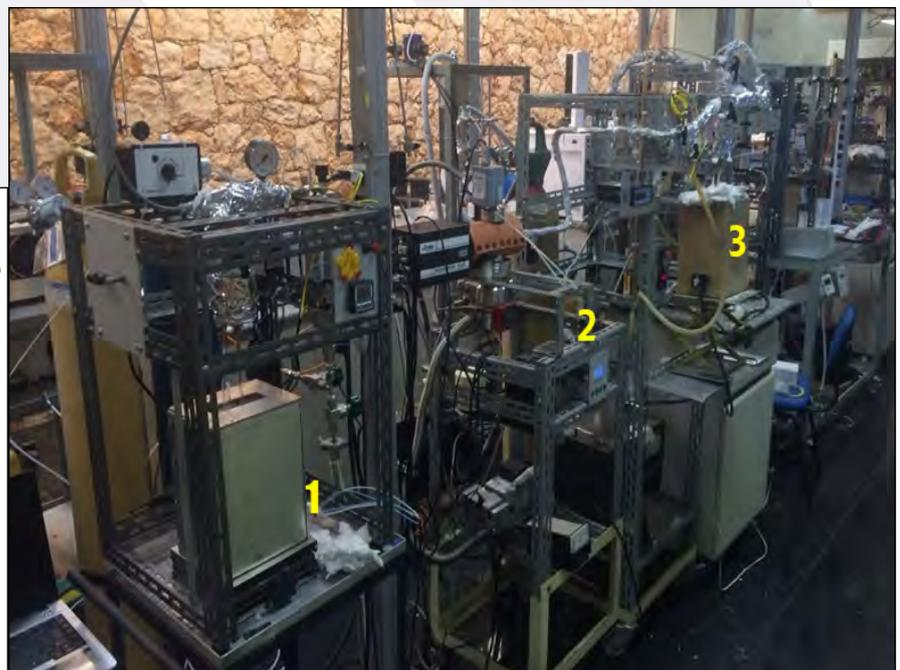
À esquerda, esquema da utilização do CO<sub>2</sub> como um oxidante na estrutura da refinaria. Autor: Nuno Batalha (in "Applied Catalysis B: Environmental", 164 (2015) 225-233). À direita, conjunto de equipamentos dedicado ao estudo do CO<sub>2</sub>. 1- Unidade geradora de misturas O<sub>2</sub> e CO<sub>2</sub> (m/z=45); 2- Espectrômetro de massas; e 3- Unidade de reação.
