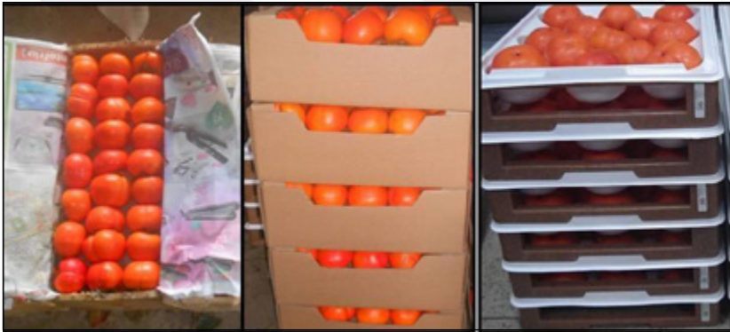
Embalagens utilizadas no experimento. Da esquerda para direita: a caixa K; a de papelão modulado; e a embalagem customizada. Foto: Maristella Martineli.
