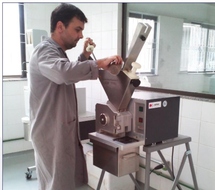
O novo laboratório (no alto) situa-se próximo à Ponte do Saber. Ele estará dotado de equipamentos sofisticados, como o moinho de facas (foto à direita), que processará o bagaço de cana para a hidrólise enzimática
