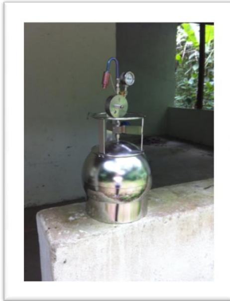
Figura 10: Foto ilustrativa de um *canister* na FT.
