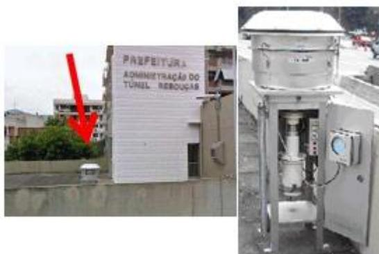
Figura 11: Foto ilustrando o AGV instalado no ponto de coleta TR.
