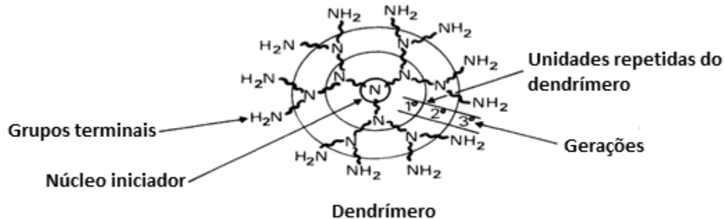
Figura 4 - Arquitetura molecular de um dendrímero. Fonte: Adaptado de Tomalia et al. 74
