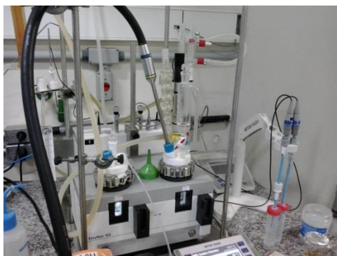
Figura 20 - Reator equipado com sonda para acompanhamento de ATR-FTIR e tempo real.
