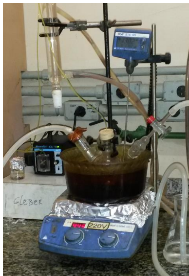
Figura 18 - Foto da aparelhagem utilizada para a síntese do poliglicerol.
