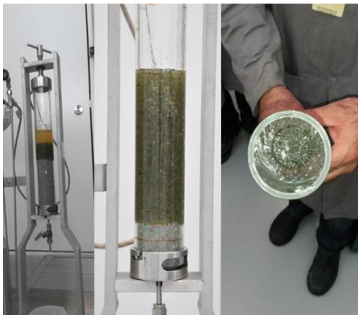
Figura 123 - Simulação de combate à perda de circulação em formação de alta permeabilidade.
