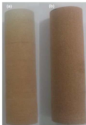
Figura 25 - Corpos de prova cilíndricos de arenito Botucatu.
