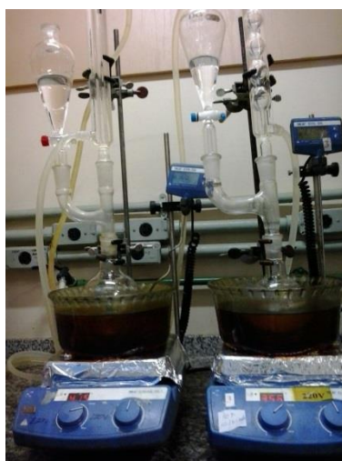
Figura 19 - Foto da aparelhagem utilizada para a síntese do poliepóxi.
