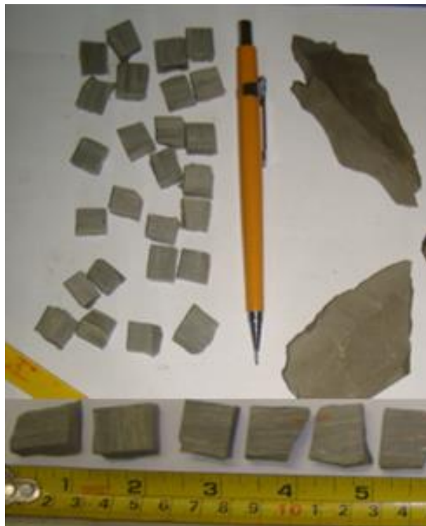
Figura 22 - Cortes de rocha utilizados nos testes de imersão.
