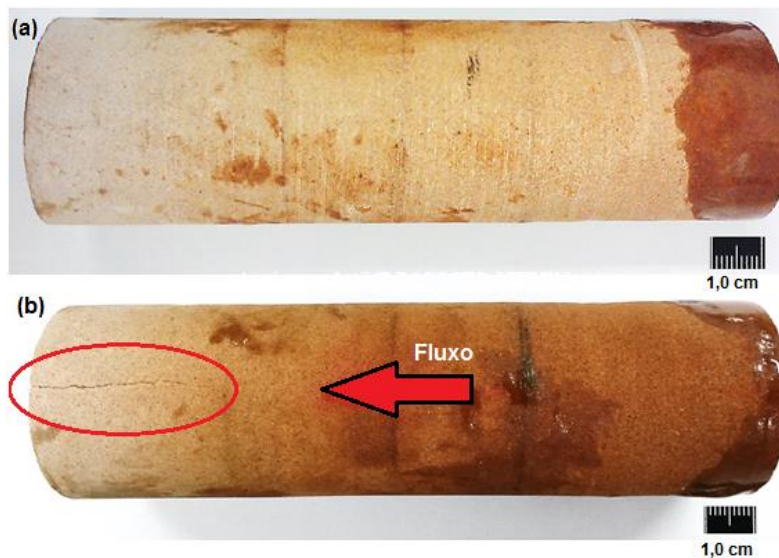
Figura 122 – Fotos do arenito resinado (R15L com endurecedor 1) e com injeção sob pressão, antes (a) e após o teste de fraturamento (b). O círculo mostra a fratura gerada.
