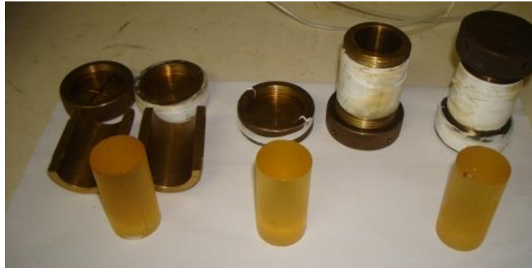
Figura 23 – Moldes e corpos de prova para os testes de resistência à compressão.
