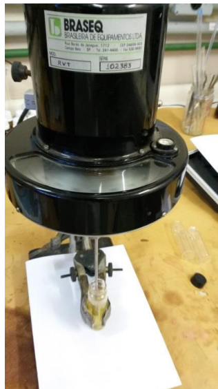
Figura 21 - Reômetro utilizado no estudo de viscosidade durante a cura da resina.
