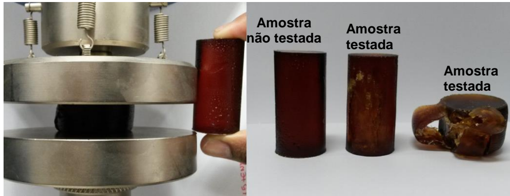
Figura 113 - Ensaio de compressão da resina R15L.
