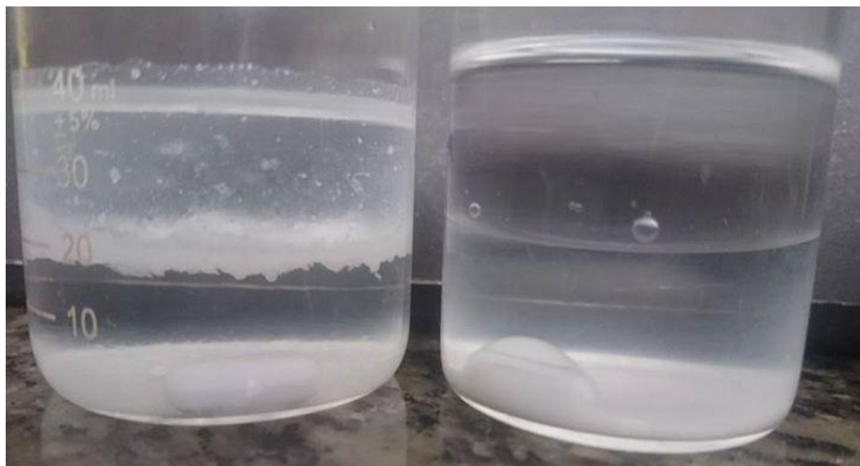
Figura 4.37 – Imagem aproximada a fim de uma melhor visualização das interfaces água/óleo. Esquerda: SBA-DEA soja; Direita: SBA-15 (Branco).
