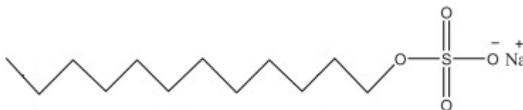
Figura 2.2 – Exemplo de surfactante, dodecilsulfato de sódio, comercialmente conhecido como SDS
