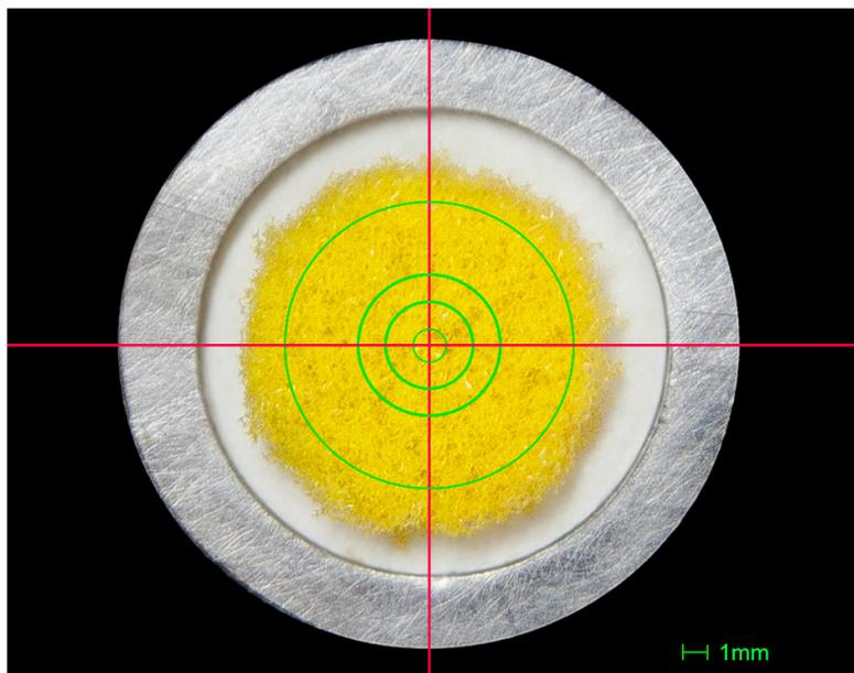
**Figura 14:** Fotografia da pastilha carregada com Au contra o feixe incidente de raios X.
