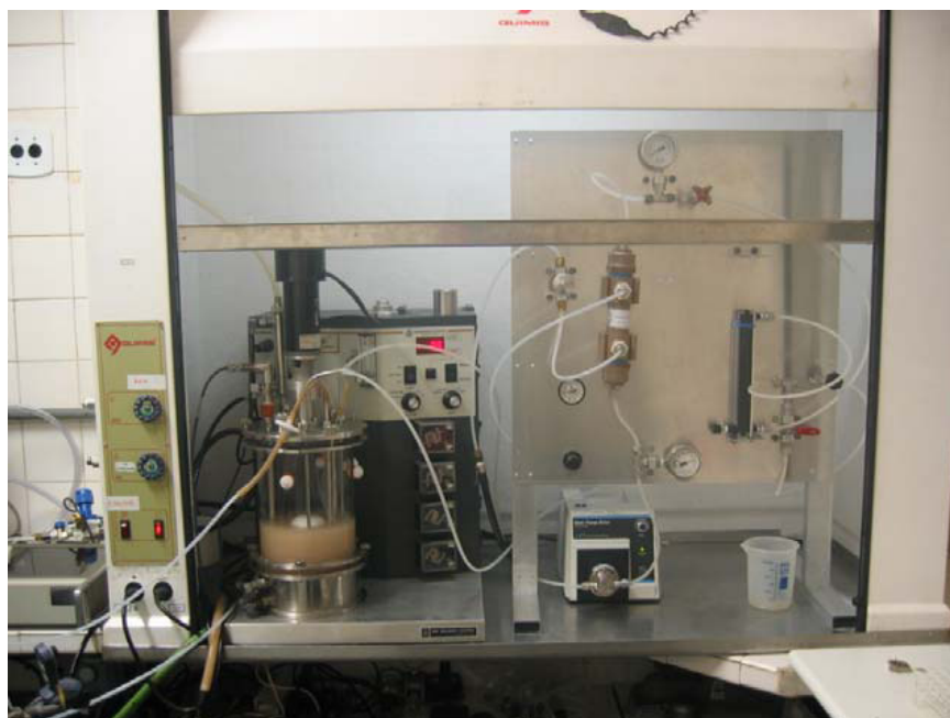
Figura 4.1 - Fermentador inserido na capela de exaustão acoplado ao sistema de oxigenação utilizando o contactor de membranas
