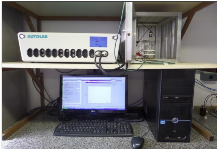
Figura 4.7: Potenciostato acoplado a uma gaiola de Faraday (contendo uma célula eletroquímica de três eletrodos) e a um microcomputador.
