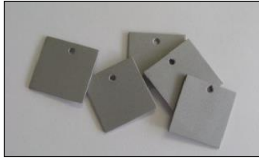
Figura 4.3: Corpos de prova de aço-carbono 1020.
