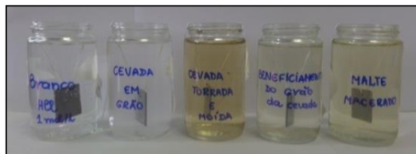
Figura 4.10: Corpos de prova submersos durante 2 h em solução sem extrato (HCl 1 mol L -1 ) e com os extratos inibidores na concentração de 400 mg L -1 .
