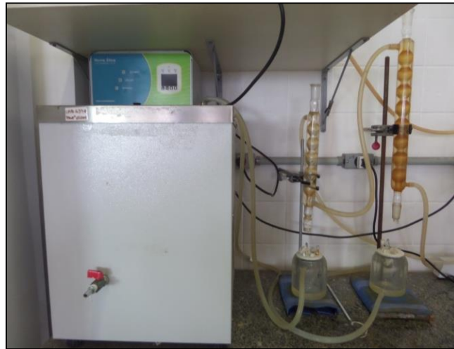
Figura 4.5: Banhos com sistema de aquecimento, utilizados nos ensaios gravimétricos com variação de temperatura ( 400 \text{ mg L}^{-1} – 4 h de imersão).
