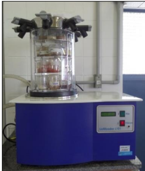
Figura 4.2: Liofilizador utilizado na obtenção dos extratos.
