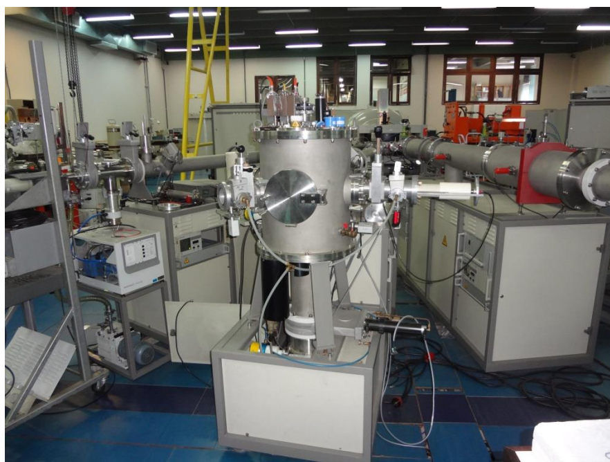
Figura 20. Acelerador de íons Tandetron - HVEE 3 MV, onde foi feita a análise por Espectrometria de Retroespalhamento Rutherford.
