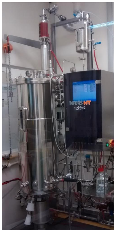
Figura 32: Biorreator em escala piloto utilizado da marca infors
