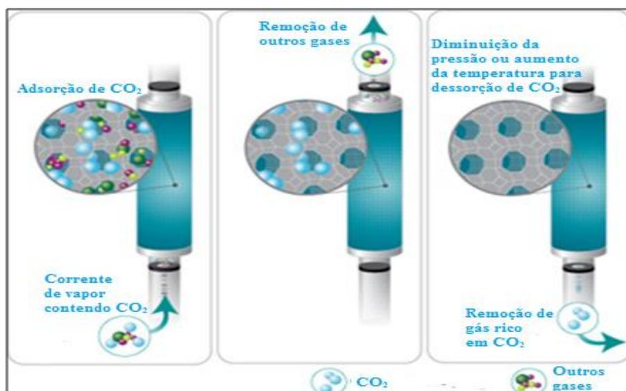
Figura 15: Esquema de captura de CO<sub>2</sub> por adsorção (Fonte: adaptado de CO<sub>2</sub>CRC).
