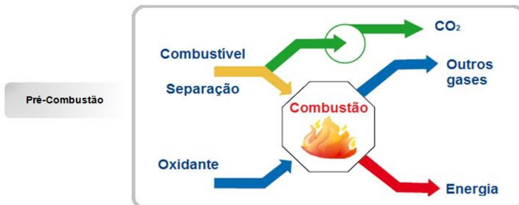
Figura 6: Esquema para captura de CO<sub>2</sub> no cenário de pré-combustão (Adaptado do IPCC, 2005).
