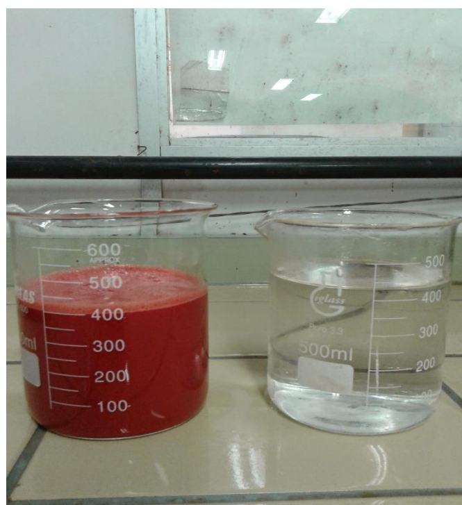
Figura 16 b: Extrato concentrado em licopeno e permeado obtidos no processo de osmose inversa.
