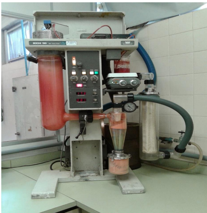
Figura 11 - Spray Dryer de bancada utilizado nos ensaios.
